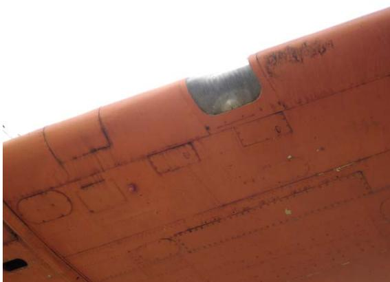
Vista de manchas provocadas pelo acúmulo de resíduos junto ao percurso das águas pluviais na asa direita do avião.
