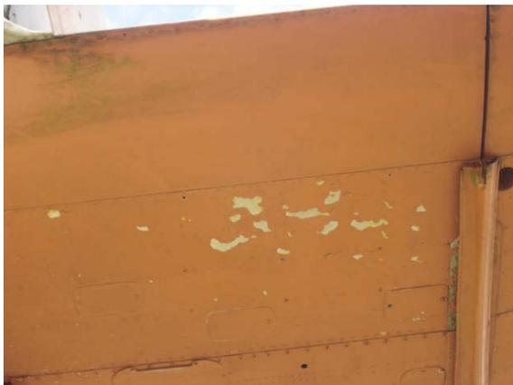
Vista de parte inferior da asa direita. Nota-se o descasque da camada pictórica e marcas de sujeira aderida.
