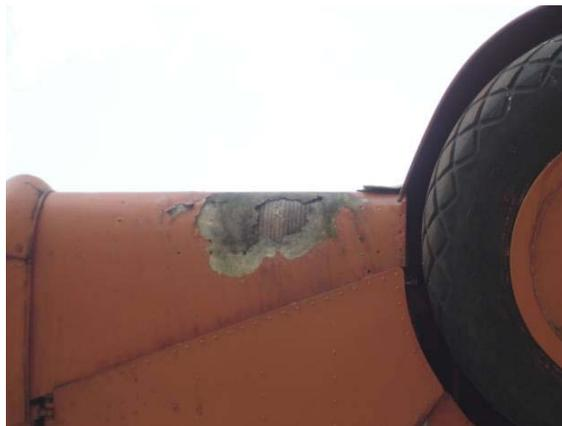
Detalhe de corrosão do revestimento em aço na borda de ataque direita da asa do avião.
