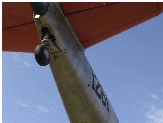
Marcas conformadas pelo acúmulo de resíduos ao longo do percurso percorrido pelas águas pluviais na asa direita e na fuselagem.
